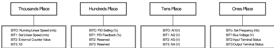
Fig. 4-14 Setting of hexadecimal parameter L1-02
